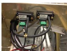
Fornisce alla ECU il valore di pressione di alimentazione. L'aria viene prelevata dal corpo farfallato e attraverso una linea pneumatica sdoppiata raggiunge i sensori.
