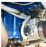
Posizionato nella parte laterale del corpo farfallato, è un sensore a 3 fili che fornisce alla ECU la posizione della farfalla. Ogniqualvolta l'ECU rileva un rapido movimento della farfalla, aggiunge carburante alla miscela per evitare che il motore perda colpi durante una rapida accelerazione. La soglia di arricchimento della miscela è regolabile durante la fase di messa a punto. Il funzionamento di questo sensore non è essenziale.
