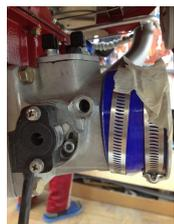
Posizionati nella parte superiore del corpo farfallato, sono sensori a 2 fili che forniscono alla ECU il valore della temperatura dell'aria all'interno del condotto di aspirazione. Questo valore consente alla centralina di operare una correzione di densità a compensazione della temperatura. Sebbene questo segnale sia importante non è essenziale per il funzionamento del sistema.
