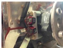
Installato sul motore, dietro alla flywheel, è un sensore a 4 cavi che fornisce alla ECU i giri del motore per la fasatura delle accensioni ed informazioni per il sistema di iniezione. Sulla flywheel sono posizionati tre magneti. Due di essi, posizionati a 180° uno rispetto all'altro, assolvono alle funzioni di timing mentre il terzo è dedicato alla sincronizzazione.
